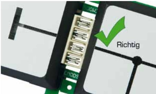
Hier ist ein Beispiel einer richtig gesteckten Verbindung. Die Verbindung besteht jeweils aus kleinen Stiften, die sich mechanisch verklemmen und dabei ebenfalls elektrisch leiten. Um eine Isolation zwischen den Kontakten zu gewährleisten und einen Kurzschluss zu verhindern sind Stege aus Kunststoff eingebracht, die den elektrischen Strom nicht leiten.
